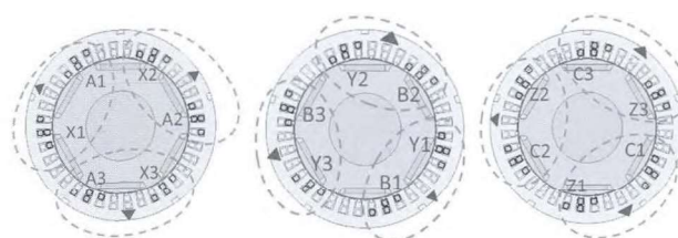
图 15 五焊槽三相绕组的对称磁路
