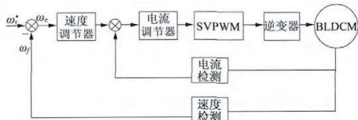
图 2 基于 SVPWM 的无刷直流电动机控制框图
