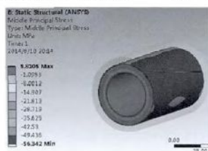
图 2 永磁体的径向应力分布
