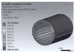
图 4 护套中的等效应力分布
